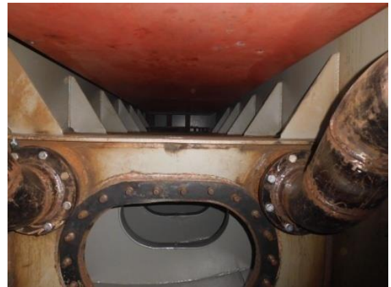
Gambar 2.1 Pondasi mesin kapal ropax 5000 GT
