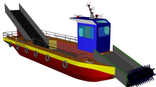
Gambar 8. Gambar 3D kapal pembersih gulma tampak samping-depan
