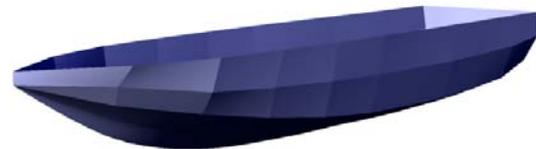
Gambar 7. Bentuk 3D Hull Form Kapal Hydrofoil
