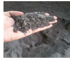
Gambar 4. Agregat halus pasir hasil pengayaan (diameter butiran 1-2 mm)
