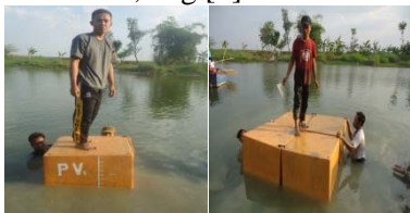
Gambar 1. Modular Floating Pontoon Ferrocement saat uji apung dan pembebanan
