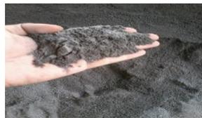
Gambar 2 Agregat halus pasir hasil pengayaan (diameter butiran < 1 mm)
