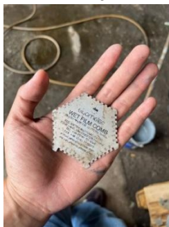
Gambar 6. Proses pengukuran wet film thickness (WFT) pada lapisan coating epoxy Hempadur Mastic 45880
