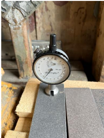
Gambar 3. Pengukuran kekasaran permukaan menggunakan roughness meter
