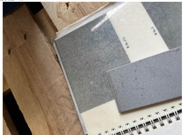
Gambar 4. Kondisi permukaan baja ASTM A36 setelah proses sandblasting dengan variasi derajat kebersihan area permukaan (SA 1, SA 2, dan SA 2½)
