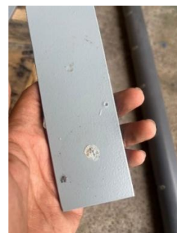
Gambar 7. Kondisi spesimen baja ASTM A36 setelah proses curing lapisan coating epoxy
