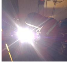
Gambar 2. Proses Pengelasan SMAW dengan posisi pengelasan 1G
