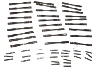
Gambar 4. Spesimen Uji Tarik dan Uji Impak
