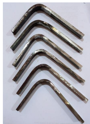
Gambar 11. Spesimen Setelah Diuji tekuk
