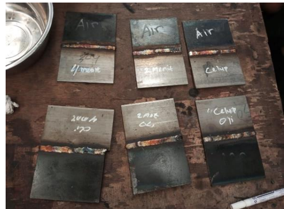
Gambar 3. Hasil Pengelasan Setelah Diberikan Media Pendingin
