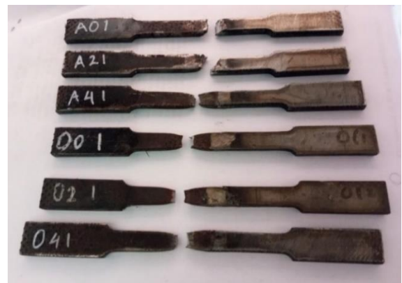
Gambar 8. Spesimen Setelah Diuji Tarik
