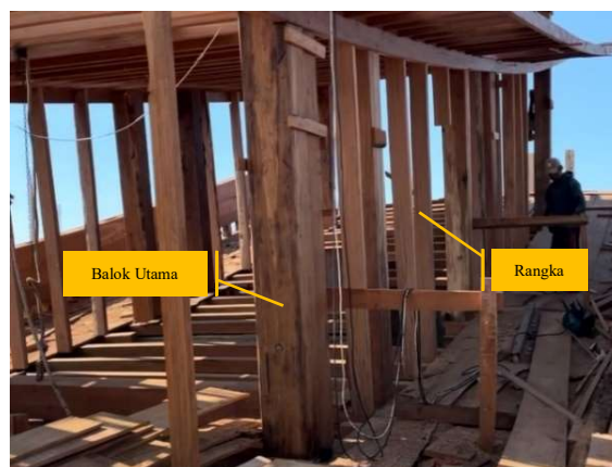
Gambar 13. Kontruksi Bangunan Utama
