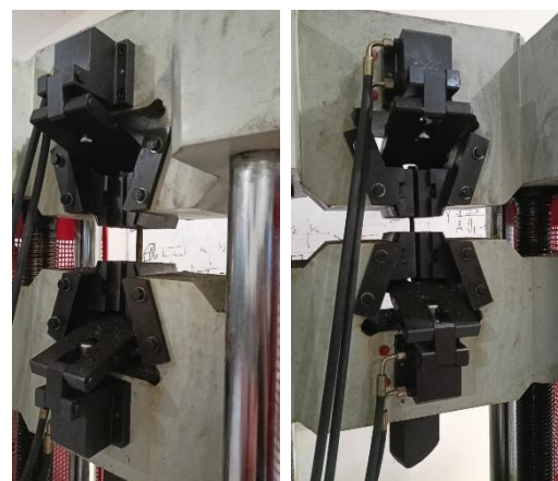
Gambar 8. Proses Uji Tarik pada Universal testing Machine
