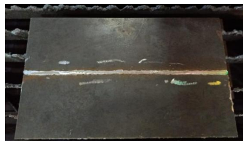
Gambar 2. Hasil Pengelasan Baja ASTM A36
