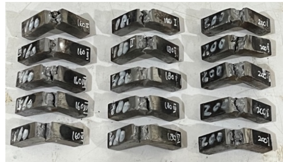
Gambar 19. Patahan spesimen impak baja ST40.
