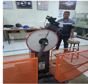
(a) Dimensi Spesimen Uji Impak (b) Mesin Charpy
