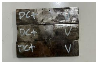
Gambar 9. Spesimen Sebelum Pengujian Tekuk
