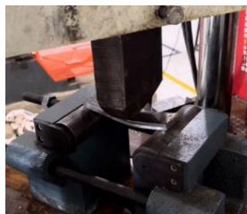
Gambar 10. Proses Pengujian Tekuk
