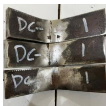
Gambar 11. Spesimen Setelah Uji Tekuk
