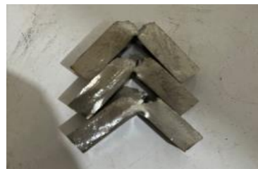
Gambar 15. Spesimen Setelah Pengujian Impact
