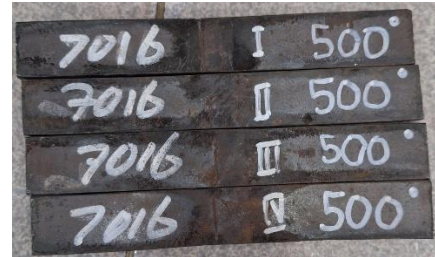
Gambar 4 Spesimen Sebelum Pengujian Tekuk
