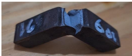
Gambar 3. 3 Spesimen setelah pengujian impak
