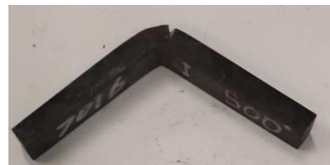
Gambar 5 Spesimen Setelah Pengujian Tekuk
