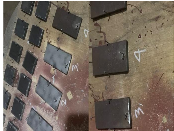
Gambar 3. Spesimen Sesudah dan Sebelum Blasting
