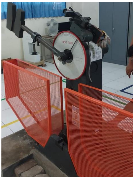
Gambar 5. Pengujian Impact Metode Charpy
