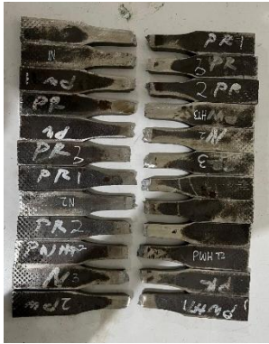
Gambar 14. Spesimen Uji Tarik Setelah Diuji
