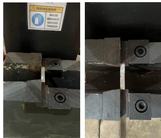
Gambar 11. Pengujian Impak dengan Impact Testing Machine
