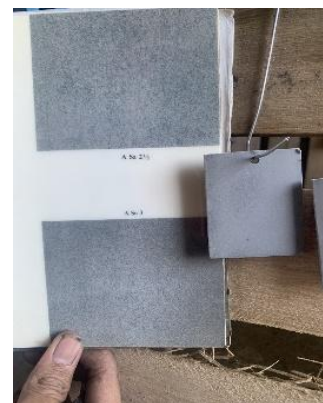
Gambar 6. Tahapan Inspeksi Visual Sandblasting
