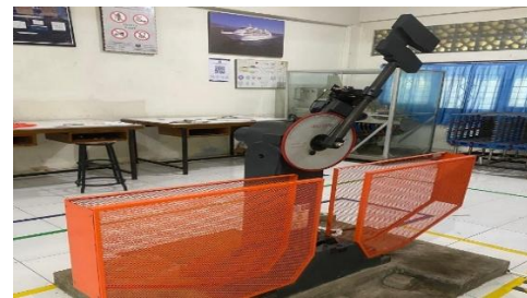
Gambar 4. (a) Dimensi Ukuran Spesimen Spesimen Uji Impak, (b) Alat Impak Test
