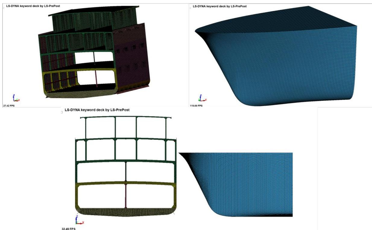
Gambar 5. Model Setelah Di-*convert* ke *Software ANSYS LS-DYNA* Serta Telah Di-*meshing* Pada *Software Altair Hypermesh*
