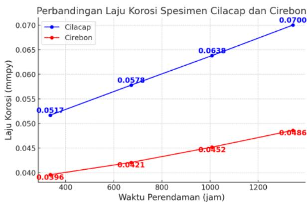
Gambar 17. Grafik Perbandingan Laju Korosi Spesimen Cilacap dan Cirebon
