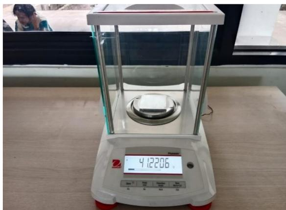
Gambar 9. Hasil Pengujian Berat Awal Spesimen
