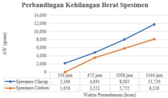
Gambar 14. Grafik Perbandingan Kehilangan Berat Spesimen Cilacap dan Cirebon
