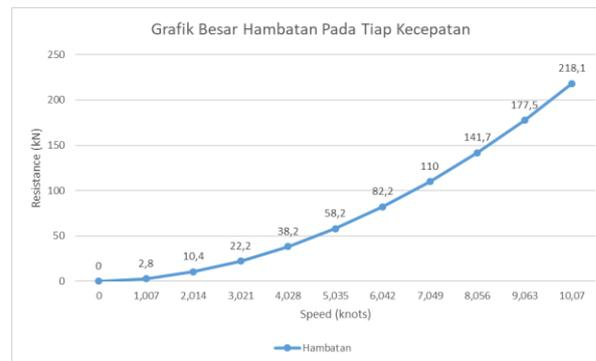
**Gambar 11.** Grafik Nilai Hambatan Kapal Pada Tiap Kecepatan
