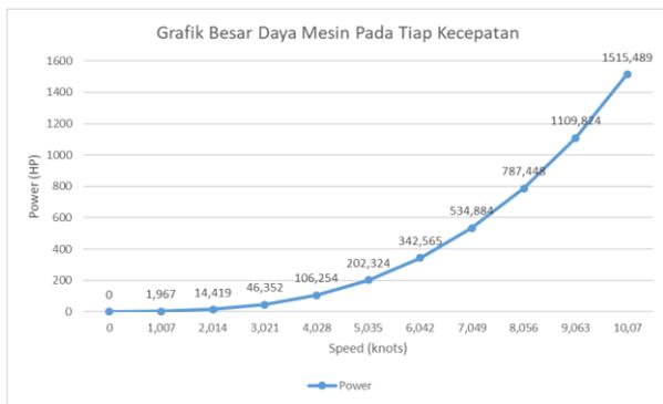
**Gambar 16.** Grafik Analisa Daya Mesin Pada Tiap Kecepatan
