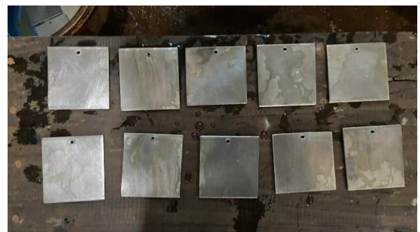
Gambar 3. Material Sebelum Proses Sandblasting
