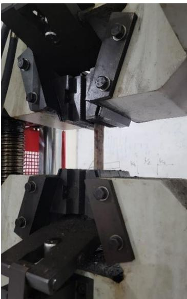
Gambar 5. Pengujian tarik menggunakan *Universal Testing Machine*
