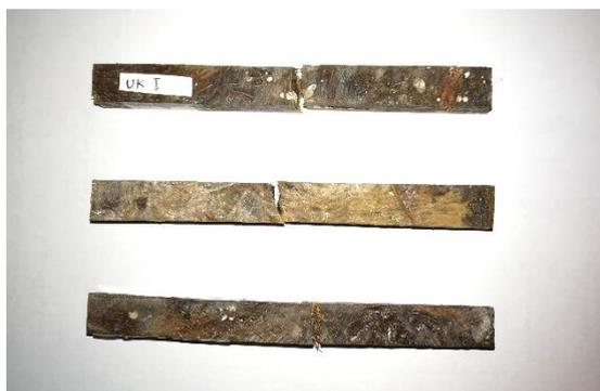
Gambar 7. Spesimen uji *bending* setelah pengujian
