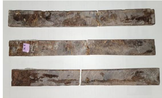
Gambar 6. Spesimen uji tarik setelah pengujian
