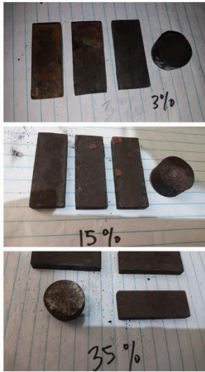
Gambar 1. Spesimen yang telah mengalami proses quenching
