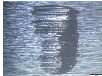
Gambar 7. Struktur Makro Uji Keausan pada media pendingin larutan garam 3%
