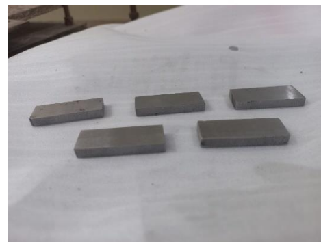
Gambar 3. Bentuk Spesimen Keausan
