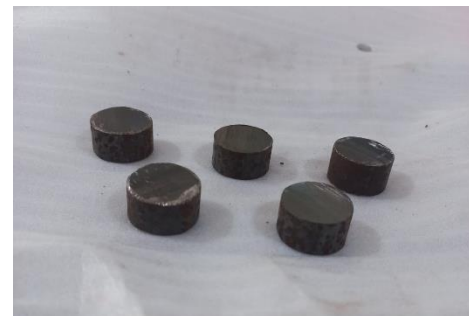
Gambar 4. Bentuk Spesimen Metalografi
