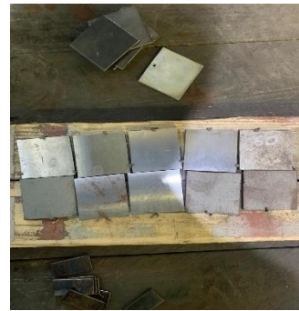
Gambar 5. Material Sebelum Proses Sandblasting
