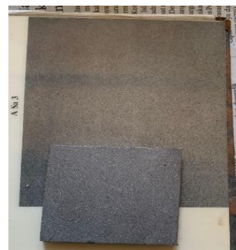
Gambar 6. Inspeksi Visual Sandblasting
