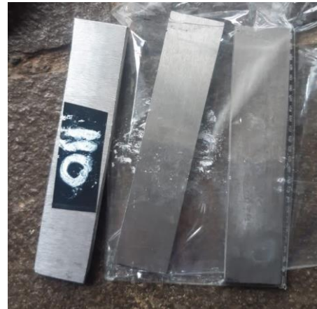
Gambar 5. Spesimen uji korosi
