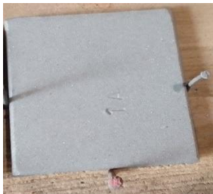
Gambar 2 Spesimen uji pasca proses Sandblasting dengan SA 2.5 sesuai ISO 8501-1
