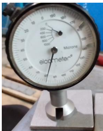
Gambar 3 pengujian kekasaran permukaan material ( Surface Roughness )
