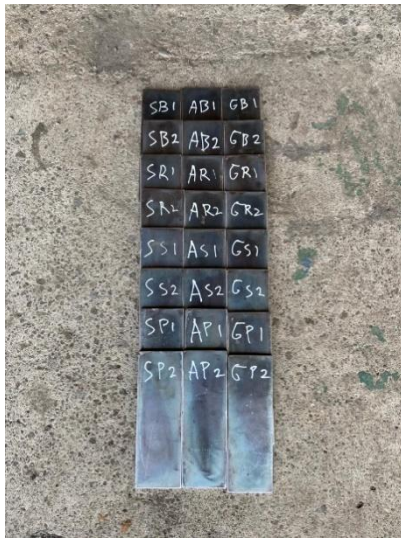
Gambar 6. Material Sebelum Blasting
