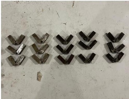
Gambar 11. Spesimen setelah dilakukan uji iMPak
