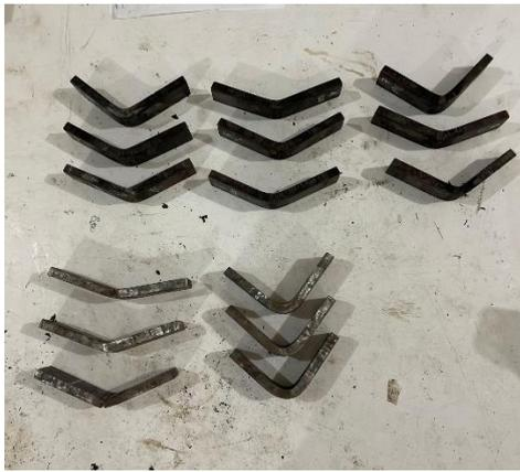
Gambar 13. Spesimen setelah dilakukan uji bending
