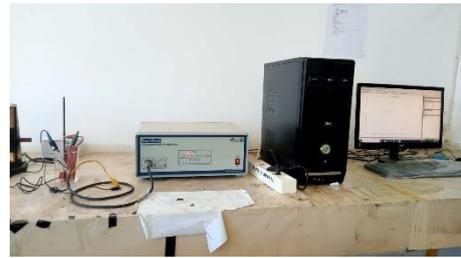
Gambar 15. Pengujian Laju Korosi
