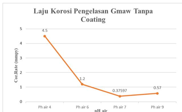
Gambar 17. Laju Korosi Pengelasan Gmaw tanpa *Coating*
