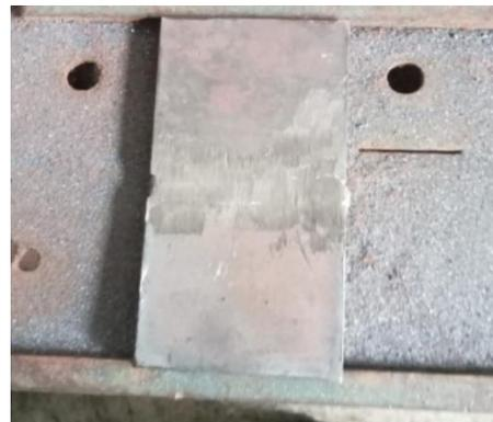
Gambar 7. Spesimen Baja A36 Setelah Proses Pengelasan
