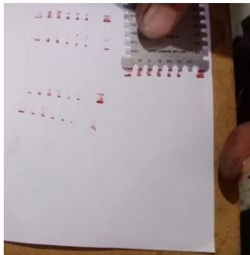
Gambar 6. Hasil Pengukuran WFT
