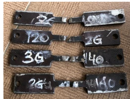
Gambar 8. Spesimen setelah pengujian tarik
