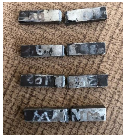
Gambar 9. Spesimen setelah dilakukan uji impact
