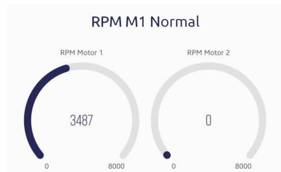
Gambar 4. Status kondisi motor saat RPM normal
