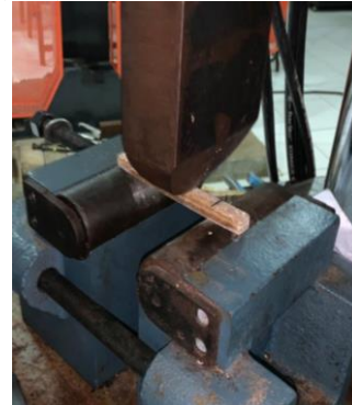
Gambar 6. Proses Pengujian Tekuk
