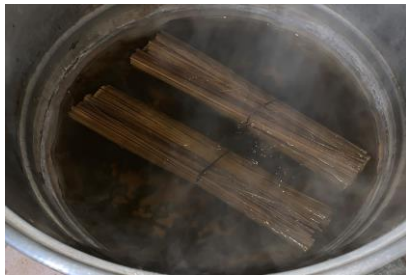
Gambar 2. Penambahan H 2 O 2 ke dalam serat bambu petung
