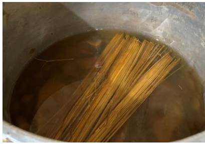
Gambar 2. Penambahan NaOH ke dalam serat bambu petung
