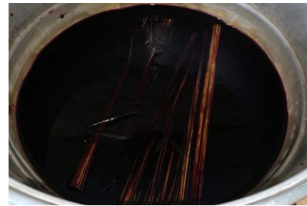
Gambar 3. Penambahan KMnO 4 ke dalam serat bambu petung
