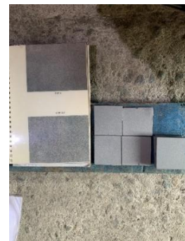
Gambar 5. Inspeksi Visual Hasil Cleanliness SA 2.5
