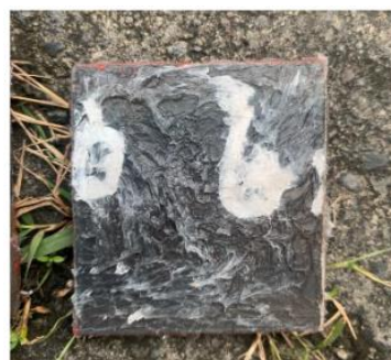
Gambar 4. Pelapisan Sealant Pada Spesimen
