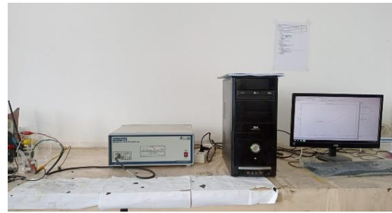
Gambar 14. Pengujian Laju Korosi
