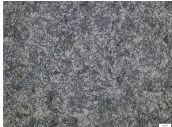
Gambar 13. Struktur mikro hasil quenching 850
