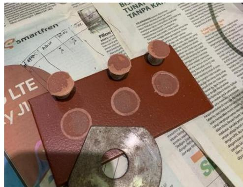
masing spesimen serta ukuran cat rata-rata dengan ketebalan 251 $\mu$ m.
