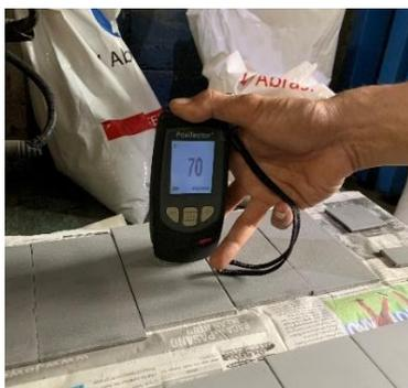
Gambar 9. Pengukuran tingkat kekasaran permukaan specimen
