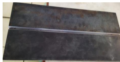
Gambar 5. Proses Pemotongan Baja A36 dan Pembuatan Sudut Kampuh
