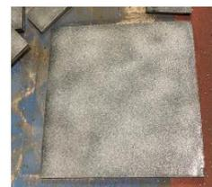
Gambar 4. Hasil setelah *sandblasting*
