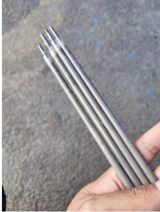
Gambar 7 Elektroda LB 52 Terbungkus Selotip
