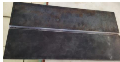
Gambar 5 Proses Pemotongan Baja SS 400 dan Pembuatan Sudut Kampuh
