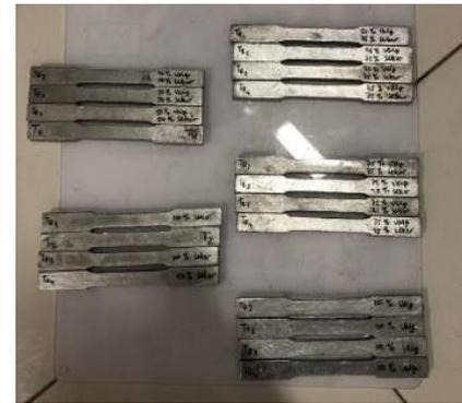
**Gambar 7. Spesimen untuk uji tarik**
