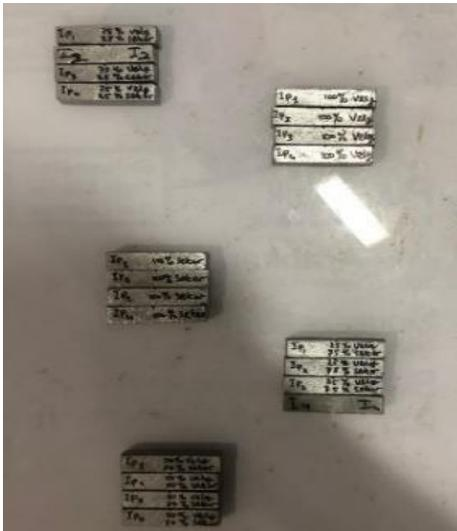
Gambar 11. Spesimen untuk uji impact
