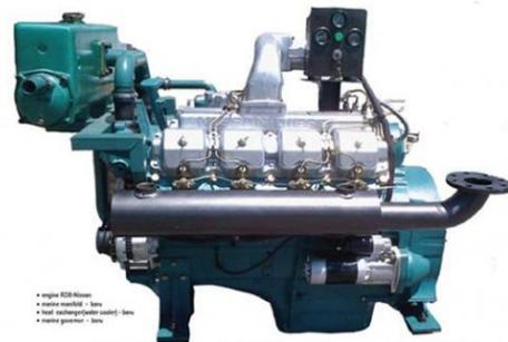
Gambar 6. Gambar Mesin Nissan RD8
