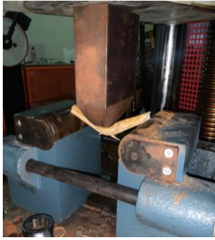
Gambar 4. Proses Pengujian Tekuk
