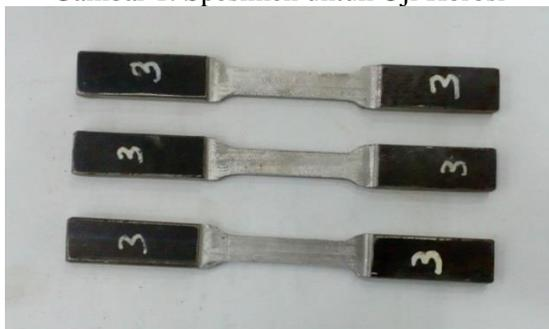
Gambar 2. Spesimen untuk Uji Tarik
