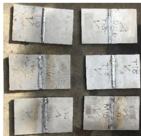
Gambar 3. Aluminium 6061 Setelah Dilakukan Pengelasan
