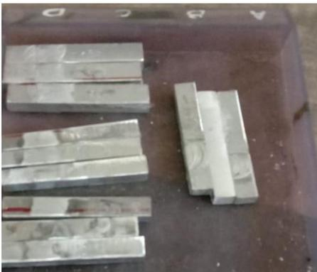
Gambar 10. Spesimen Uji Kekerasan Vickers
