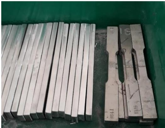
Gambar 6. Spesimen Uji Tarik
