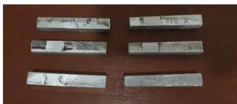
Gambar 11. Aluminium Setelah Uji Kekerasan *Vickers*
