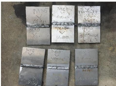
Gambar 3. Aluminium 6061 Setelah Dilas dan Didinginkan
