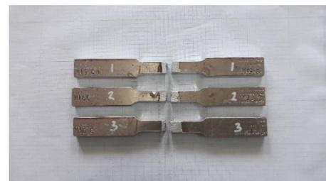
Gambar 7. Aluminium Setelah Uji Tarik
