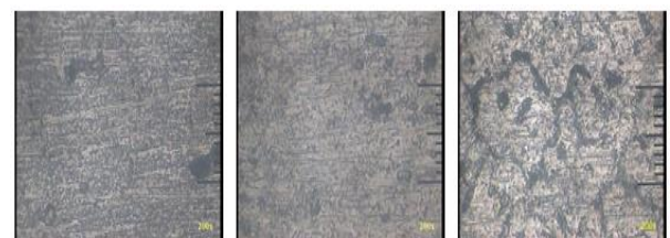
(BM) (HAZ) (Las) Gambar 14. Struktur Mikro TIG Air Tawar
