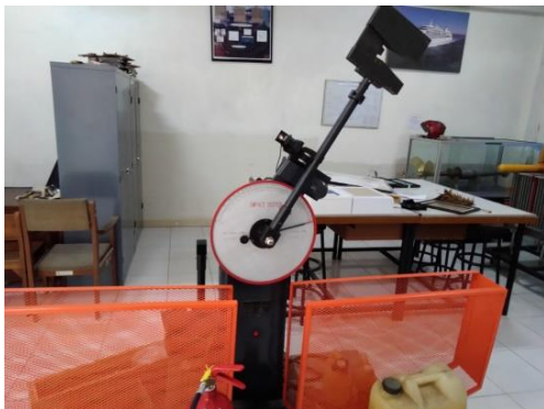
Gambar 5. Alat uji impact (Lab. Pengelasan Teknik Perkapalan Universitas Diponegoro)
