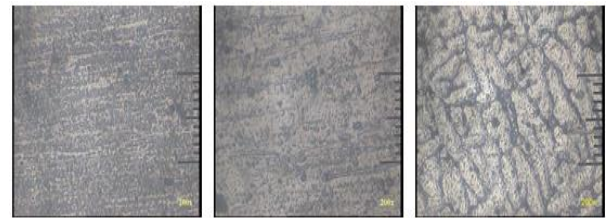
(BM) (HAZ) (Las) Gambar 12. Struktur Mikro MIG udara
