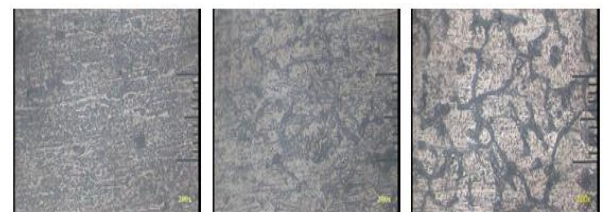
(BM) (HAZ) (Las) Gambar 12. Struktur Mikro TIG udara
