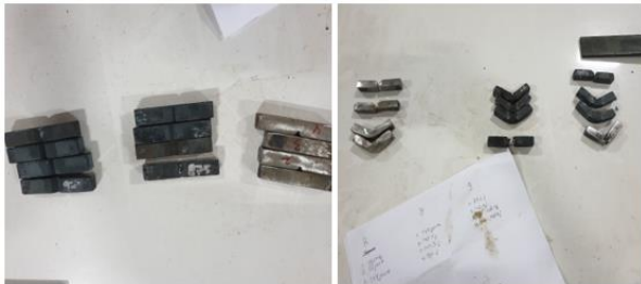
Gambar 14. Spesimen Uji Impak Sebelum dan Sesudah Pengujian
