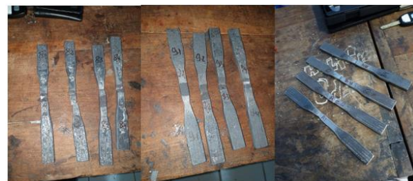
Gambar 10. Spesimen Uji Tarik Setelah Pengujian
