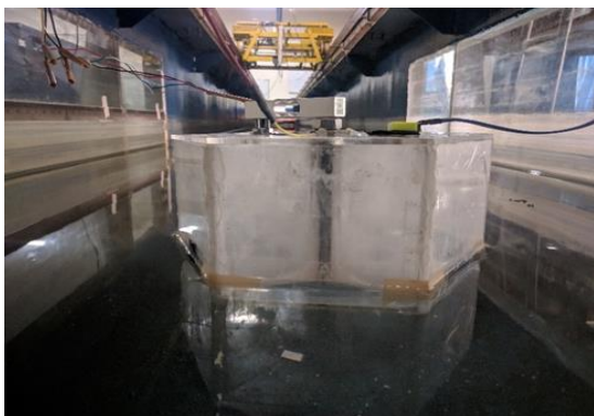
Desain 10. Pengukuran olah gerak pada towing tank
